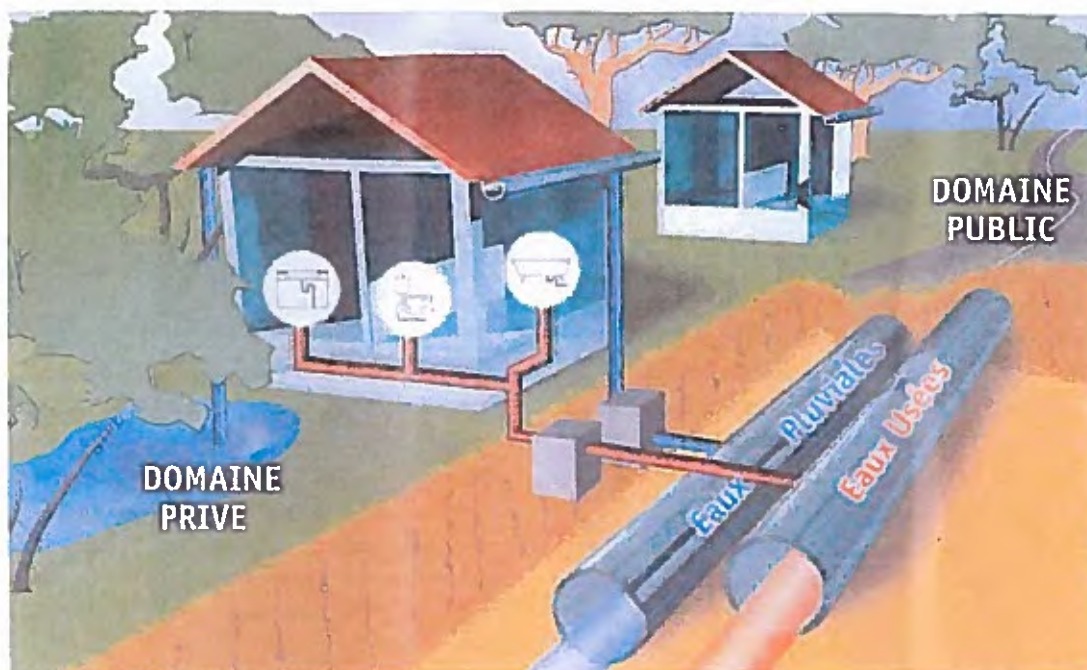
SCHÉMA GÉNÉRAL DE RACCORDEMENT À L'ÉGOUT ET DE BRANCHEMENT. Source : AEAP
