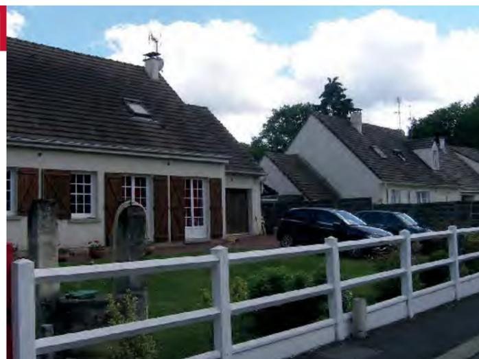
Construites avec des techniques industrialisées en parpaing de ciment ou en brique creuse, les façades sont généralement enduites et/ou peintes avec des produits prêts à l'emploi. Les fenêtres ont des proportions horizontales.
