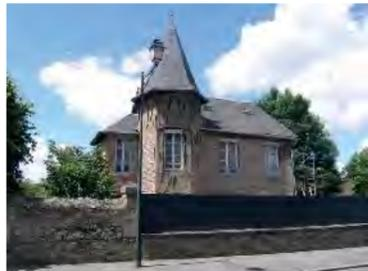
La variété des proportions de baies et la variété des natures des fermetures (persienne métallique repliable en tableau ou volet), des équipements (fenêtre, lambrequin, garde-corps) et des formes (arc, linteau droit, insertion d'un profilé métallique) caractérisent fortement la maison de la fin XIX<sup>e</sup> - début XX<sup>e</sup>.
