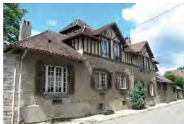
Les compositions libres, axées, symétriques caractérisent la typologie. Le matériau de couverture (ardoise ou terre cuite) est dépendant des pentes dédiées au projet de toiture. Les encorbellements sont fréquents et permettent l'apparition du bois de décor (faux-pans de bois) en couronnement de façade.
