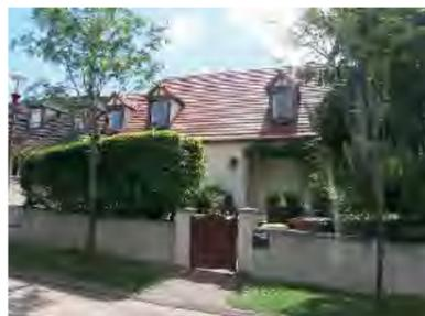
La toiture est systématiquement recouverte de tuiles mécaniques de couleur brune à orange foncé. Les clôtures sont grillagées, maçonnées partiellement avec un grillage ou serrurerie, parfois doublé de végétation. Certaines maisons adoptent la clôture cavalière blanche faite de poteau et de lisses.
