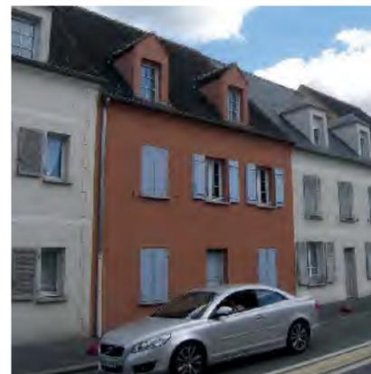
Le béton et l'enduit sont les matériaux courants des façades. Les fenêtres et les lucarnes, d'inspiration traditionnelle, tentent une insertion par mimétisme. Les façades sont sobres et seuls une corniche et un appui de baie animent la façade.
