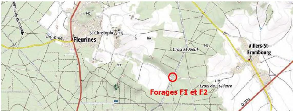
Les forages F1 et F2 captent la nappe contenue dans les fissures de la partie basale des calcaires du Lutétien et les pores des sables plus ou moins grésifiés des sables du Cuisien. Ces deux niveaux aquifères sont en continuité hydraulique. L'eau pompée subit une chloration. À court terme, une station de traitement (station de déferrisation) sera mise en place afin de diminuer concentrations en fer.
